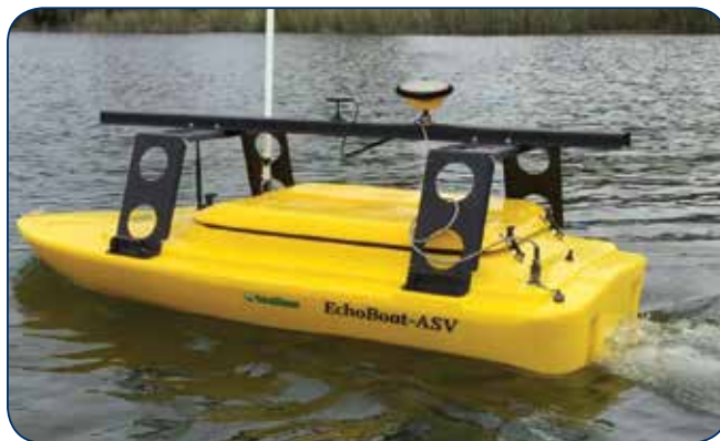
EchoBoat-ASV™ con un sonar multihaz e integrado a un INS / IMU
